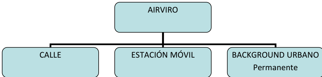
Figura 5.2: Diseño de la Red de Monitoreo para Transantiago. Para una gestión eficiente de la información todos los monitoreos deben estar conectados en línea.
